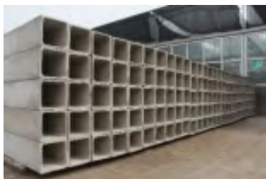
机制水泥通风道
